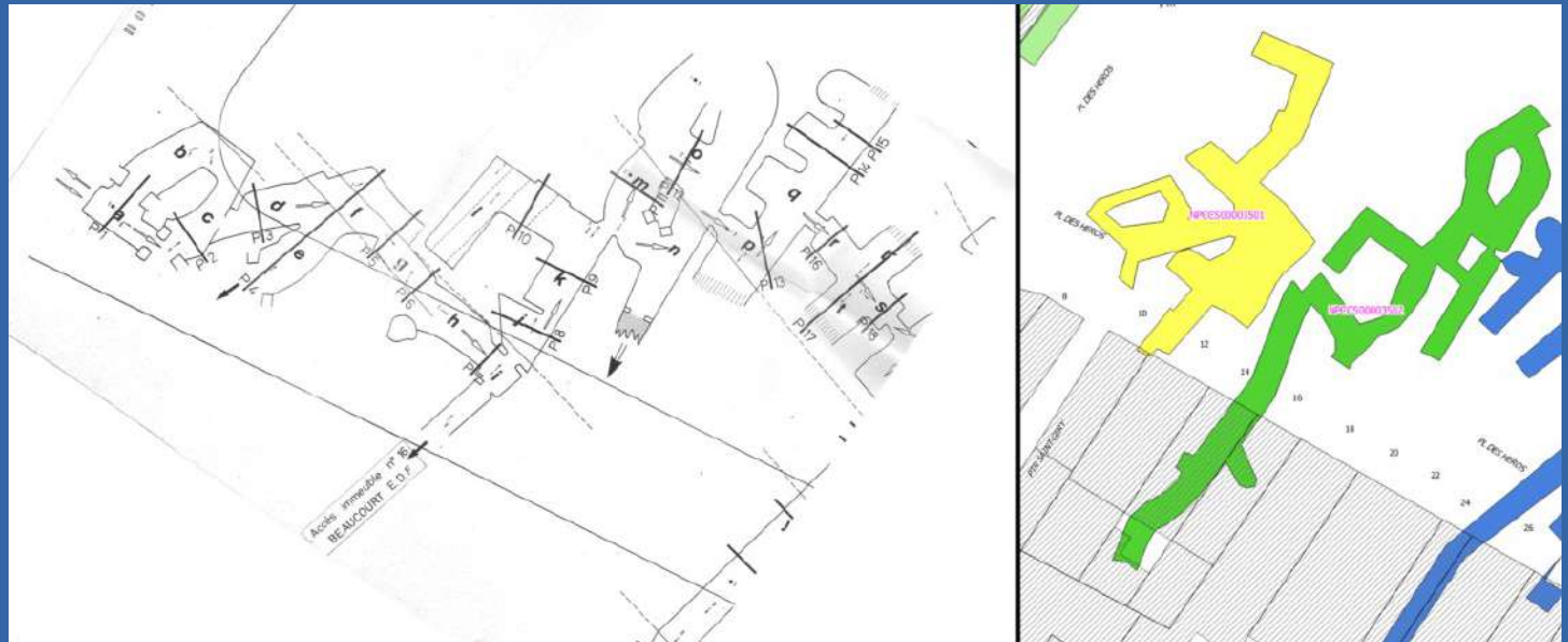
Discordance entre le plan annexé à la fiche BRGM (ARR130 et ARR133) et emprise des cavités fourni par le BRGM.
