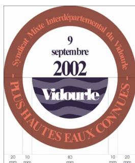
Exemple de repère de crue
